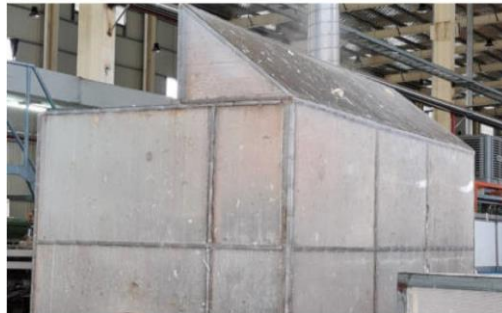
รูปที่ 5 อุปกรณ์ครอบกันเสียงของโรงงาน
